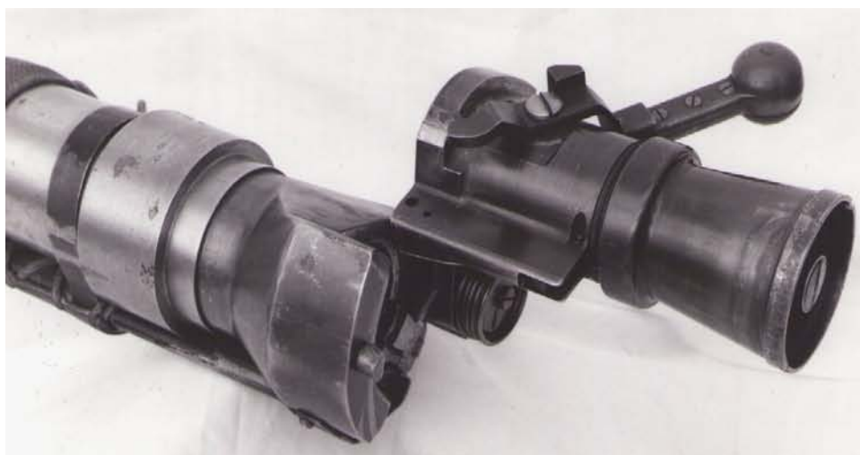
Bilderna ur Eskilstuna museers arkiv visar 37 mm granatgevär (tryckmätning vapen) fm/43 ovan samt laddblindpatron nedan (eldröret är ett avkortat eldrör till marinkanon m/95)
