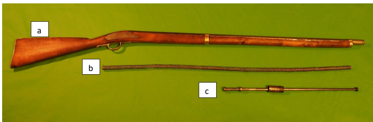
Figur 1: a= bajonettfäktningsgevär, b=mässingfjäder, c= bajonett med styrningar och piphylsa.
