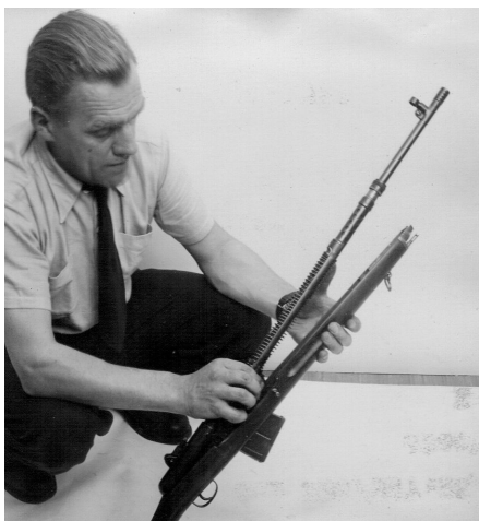
Bild 4 - gasregulatorn skruvas ca 5 mm framåt varefter handskyddet borttages
