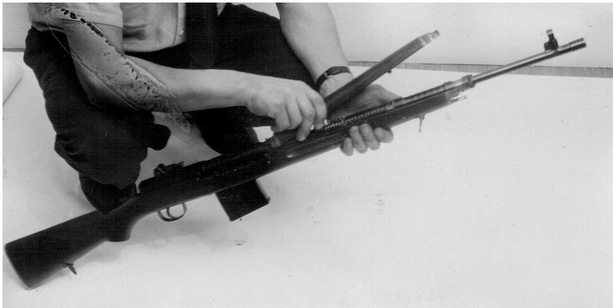
Bild 4 - gasregulatorn skruvas ca 5 mm framåt varefter handskyddet borttages
